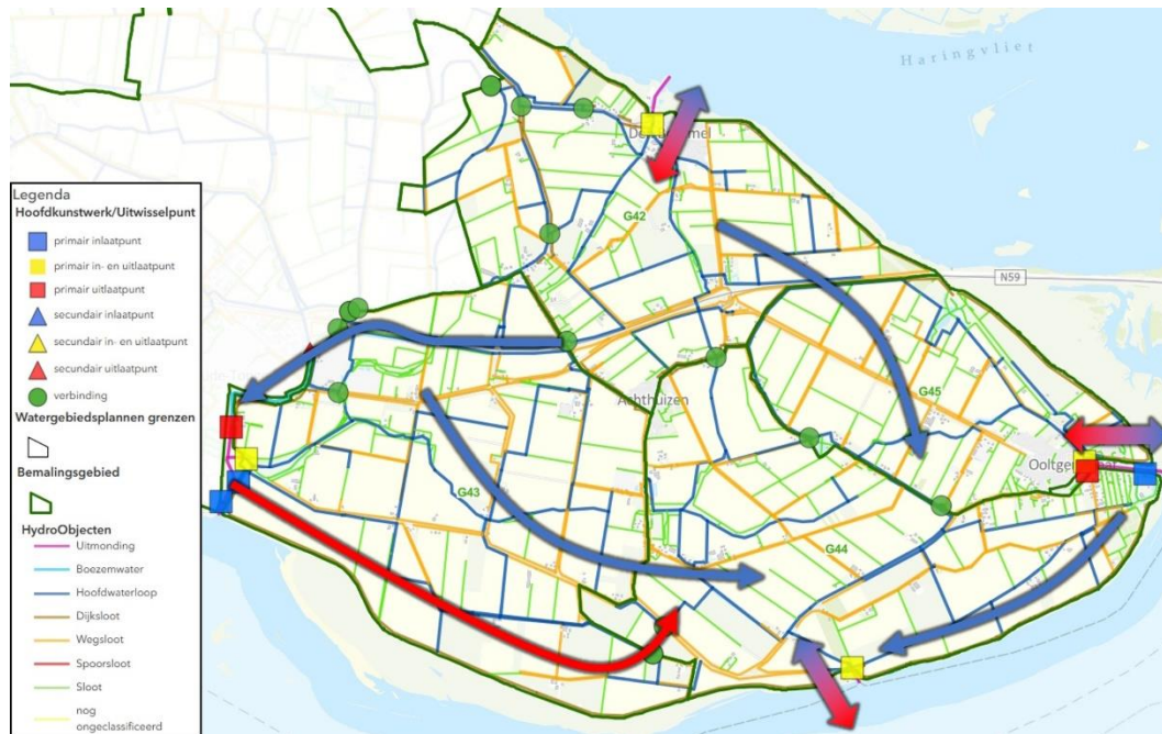
Figuur 2: Watersysteemkaart Flakkee Oosthoek met bemalingsgebieden, hoofdkunsten, waterlopen en stroomrichtingen (blauwe pijlen geven de afvoerrichting aan en rode pijlen de aanvoerrichting in geval van droogte).
